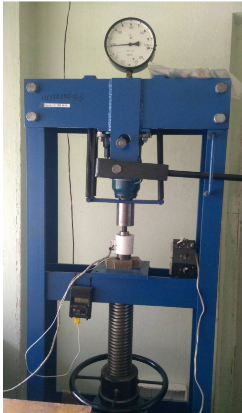
Рис 2.1 Установка за допомогою якої виготовлялись композитні матеріали
