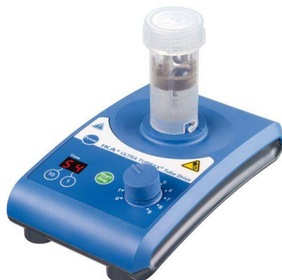
Рис. 2.1. Гомогенізатор IKA ULTRA TURRAX Tube Drive –а), установка для гарячого пресування порошкових композитних матеріалів –б)
