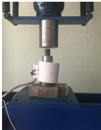
Рис. 2.1. Гомогенізатор IKA ULTRA TURRAX Tube Drive –а), установка для гарячого пресування порошкових композитних матеріалів –б)
